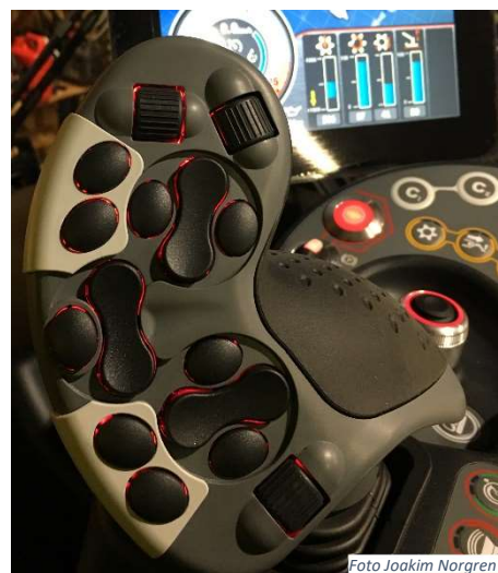
Joystick för att manövrera pistmaskin, svindlande många funktioner
