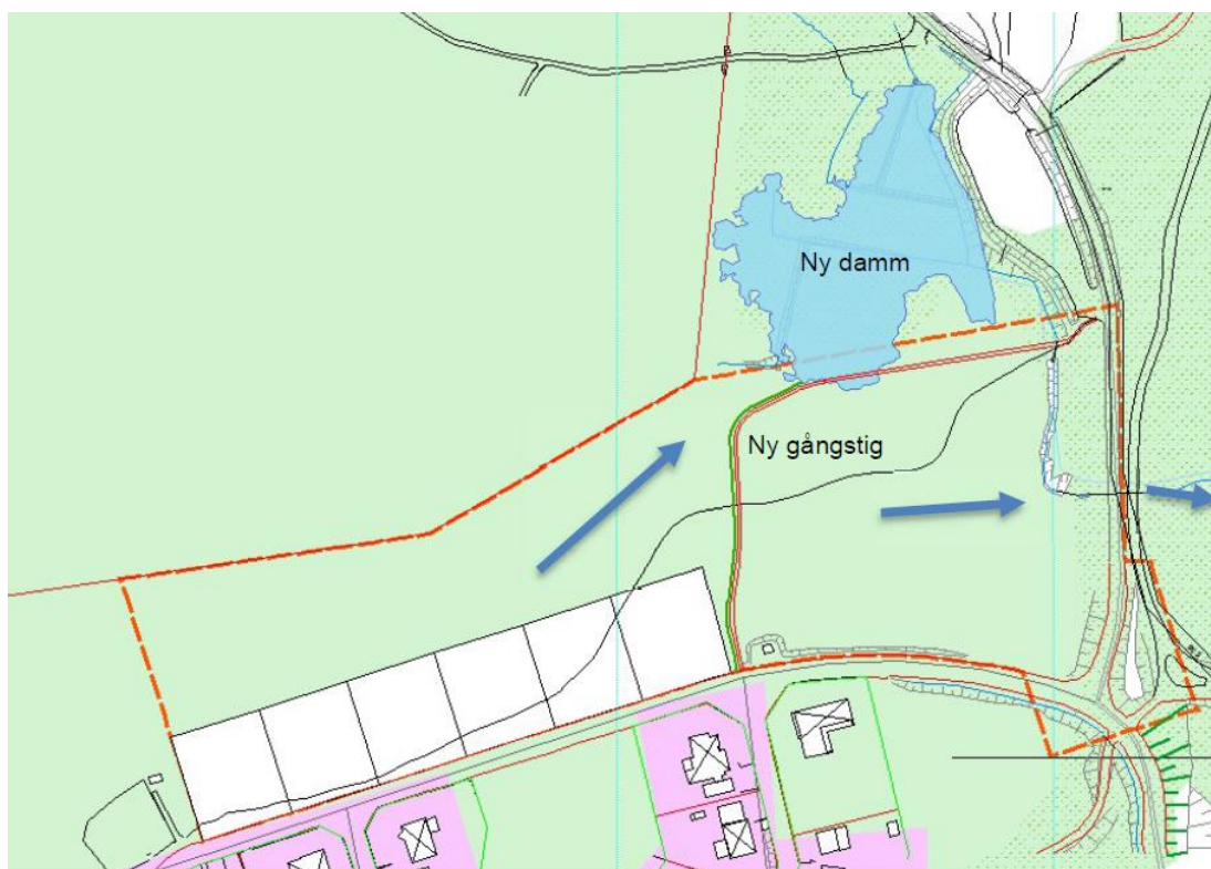
Utdrag ur dagvattenutredning upprättad av Tyréns AB. Gångstig illustreras med rödlinje, nytt skåldike med grön linje. Blå pilar illustrerar rinnvägar. Obs gångstogens placering är reviderad i plankartan för att kunna möjliggöra en mer naturlig utbredning av dagvattendammen.
