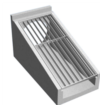
Bild 2. Principbild vägtrumma, byggkatalogen.byggtjanst.se. 2024
