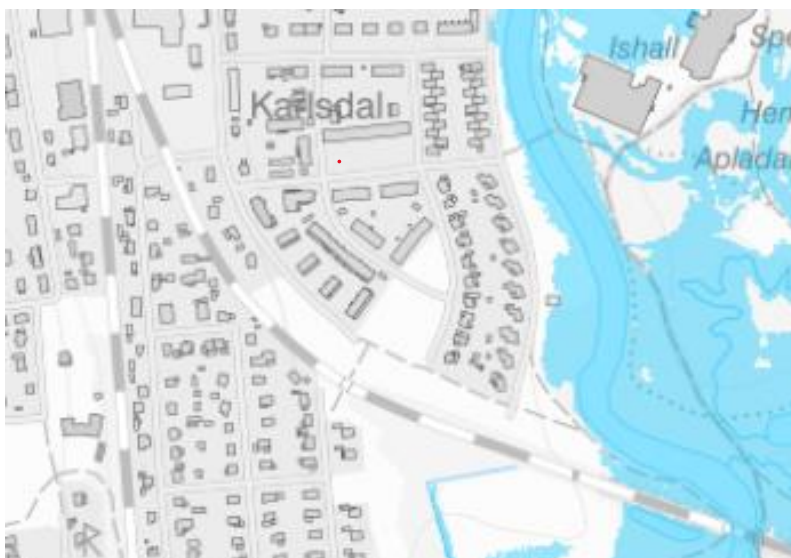
Beräknad utbredning vid översvämning, 100-årsregn, Sveriges geotekniska institut (SIG) webverktyg
