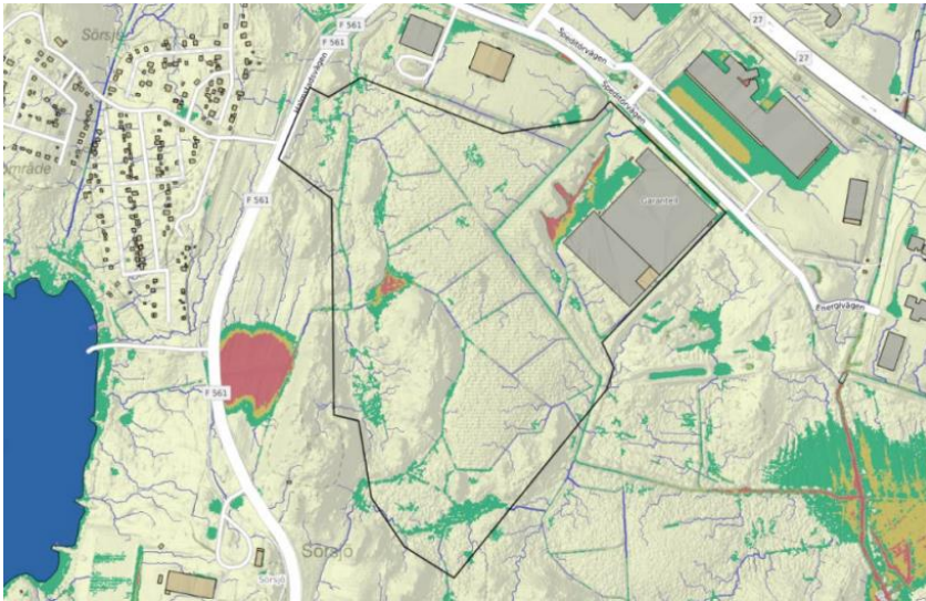
Skyfallsanalys från dagvattenutredningen, utförd i Scalgo Live. 50 mm. Grönt= 0–30 cm, gult 30–50 cm, rött >50 cm.
